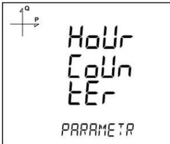
El dispositivo puede contar el tiempo cuando un parámetro seleccionado excede o cae por debajo de un valor límite ajustado. Esta función se explica en esta sección.
