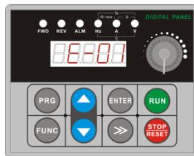
Fig 3-4 Alarma de fallo Indicación de sobrecorriente durante la aceleración
